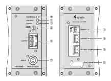
① アンププロテクションインジケーター 出力トランジスタやスピーカーなどを保護するためアンプ内部の保護回路が働いた 場合に赤色に点灯します。
