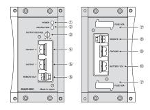
① 電源 ON/OFF インジケーター 本機作動中に青色に点灯します。 Power LED Indicator Illuminates when A-100A is on (Blue LED)
